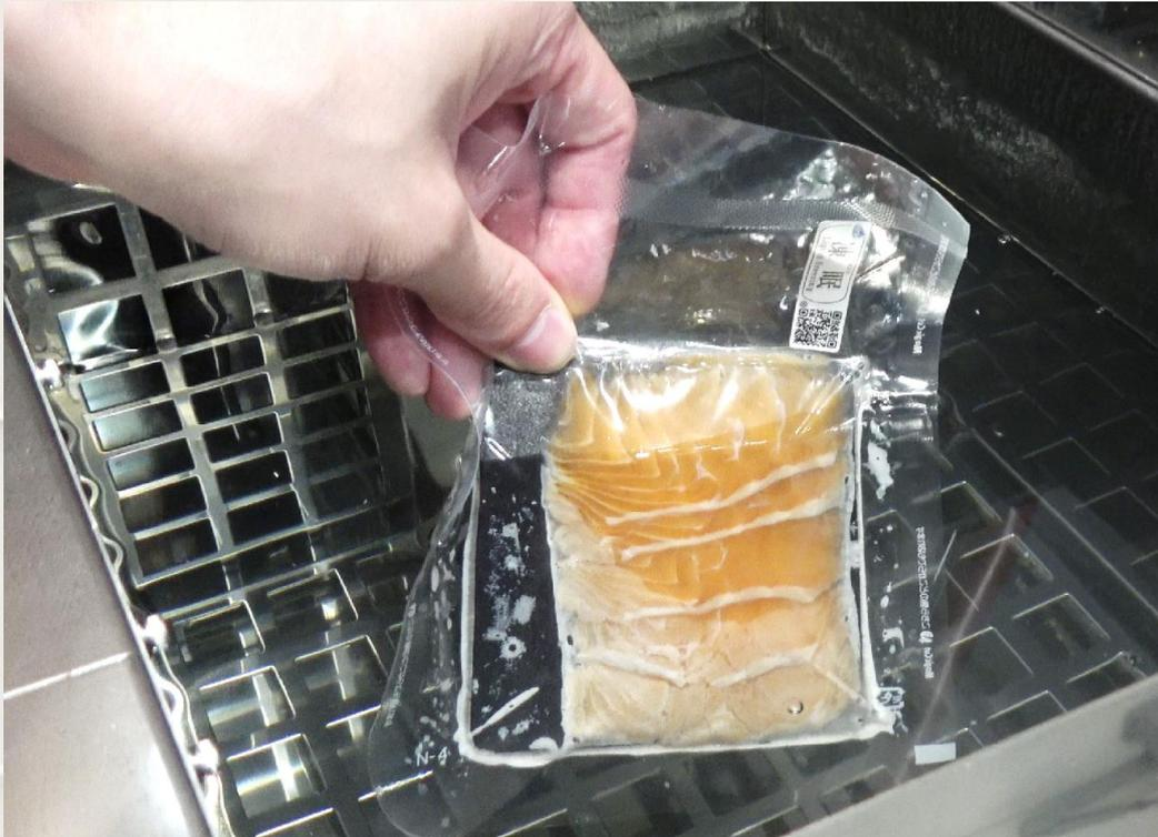
パックした食品を **-30°Cのアルコール** で凍らせる手法で、テクニカンが確立、特許も取得しました。空冷式の急速冷凍では実現しえなかった冷凍技術により、「作りたて」「チルド」に限りなく近い味わいのまま保管することが出来ます。
